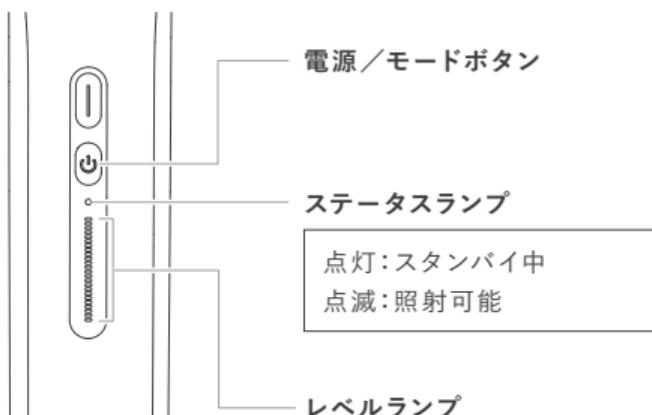
2 電源／モードボタン(①)を短く1度押して、モードを切り替える。
